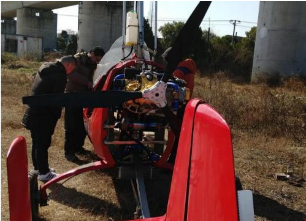
图 2-2 对 1500 系列发动机进行现场测试
